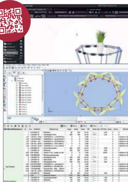
per il software di programmazione del centro di lavorazione. È in corso una collaborazione con Homag (\*.mpr), IMA (\*.fmc), SCM/Morbidelli (\*.xml), HOLZ-HER e Biesse (\*.hops/\*.cix), Format4 (\*.tnc) e Ganner (\*.ascii).
